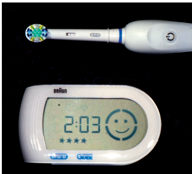
FIG. 3 Spazzolino elettrico con timer per la visualizzazione del corretto tempo di spazzolamento e pressione.
