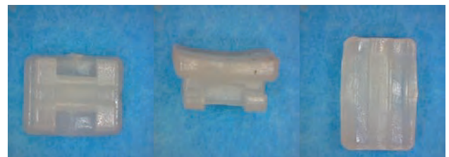
FIG. 11 Attacco in resina acetilica atossica.
