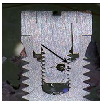
FIG. 3 Si nota lo scarso adattamento della vite di serraggio alla filettatura dell'impianto.
