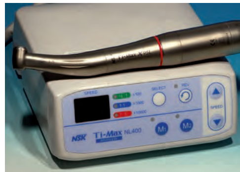
FIG. 46 Manipolo contrangolo moltiplicatore ad anello rosso, utilizzato con punte e frese con attacco FG, è largamente adoperato in diversi settori dell'odontoiatria; rispetto alla turbina presenta un numero di giri/minuto inferiore, consentendo una maggiore precisione nell'asportazione di tessuto dentale.
