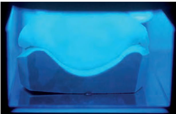
FIG. 10 Polimerizzazione del foglio di resina.
