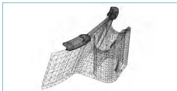
FIG. 55 File STL del tubo linguale verticale autobloccante, vista laterale.
