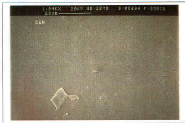
Foto 7 - Osservando la medesima zona al SEM 1040x, apprezziamo l'eccezionale levigatezza superficiale di questo materiale.
